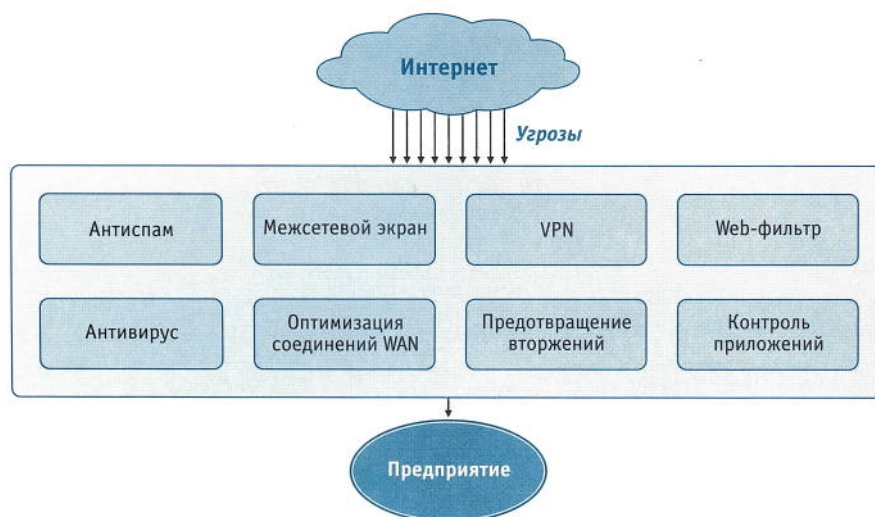
Рис. 2. Защита сети с помощью UTM-устройства
